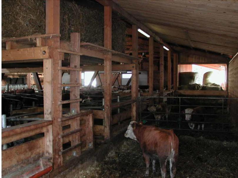
Bild 2: Befahrbarer Kälberschlupf an der Stallaußenseite zum Entmisten mit Frontlader. Ein Strohzwischenlager auf der Bühne erleichtert das Einstreuen.
